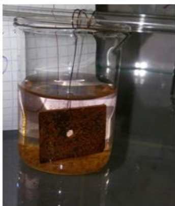
Рис. 2. Водяная нефтяная система с водопроводной водой
