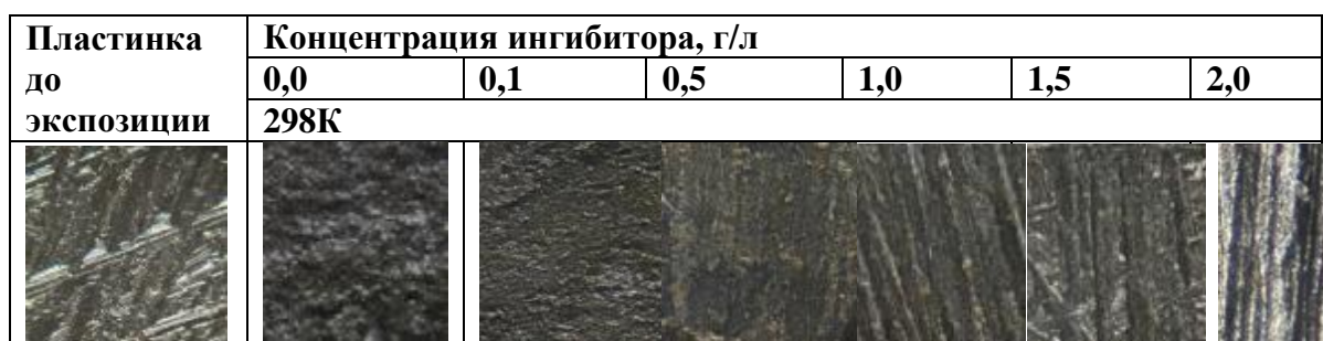
Рисунок 3. Микрофотография поверхности стальной пластинки ( \times 50 ) до и после 24-часовой экспозиции в растворе ортофосфорной кислоты 0,5 моль/л при различных концентрациях водного экстракта P. aviculare L. при 298К
