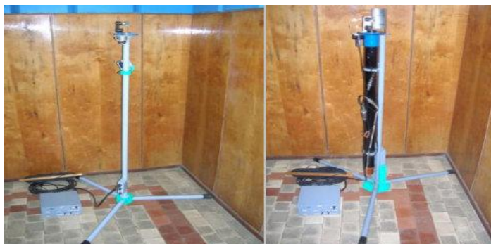
Сурет 51 - Қоймадағы тұқымдарды өңдеуге арналған лазерлік құрылғы (Патент 375530, № 2202869)
