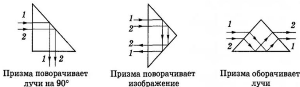
Рис.36. Прохождение лучей через трехгранные призмы
